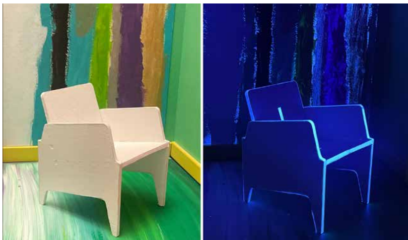
Fot. 5. Mebel do makiety pokryty materiałami o zbliżonej barwie, lecz odmiennych właściwościach. Źródło: projekt, wykonanie i fotografie własne
